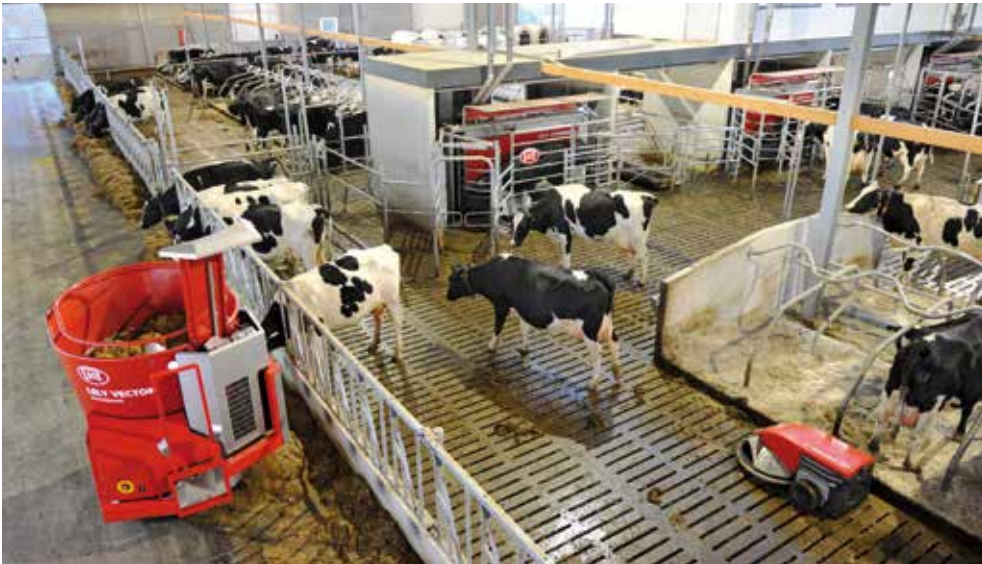
Lely apparatuur in actie. Achter in de stal de Lely Astronaut, automatisch melksysteem. Links de Lely Vector, automatisch voersysteem, en rechts de Lely Discovery, mestrobot.
